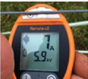
Photo 47 : Test d'intensité sur clôture électrifiée ©MNE / EED
