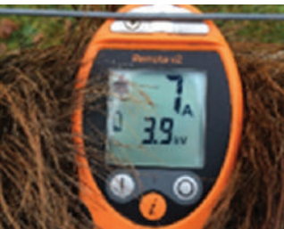
Photo 48 : Test d'intensité sur clôture électrifiée avec peau de sanglier ©MNE / EED
